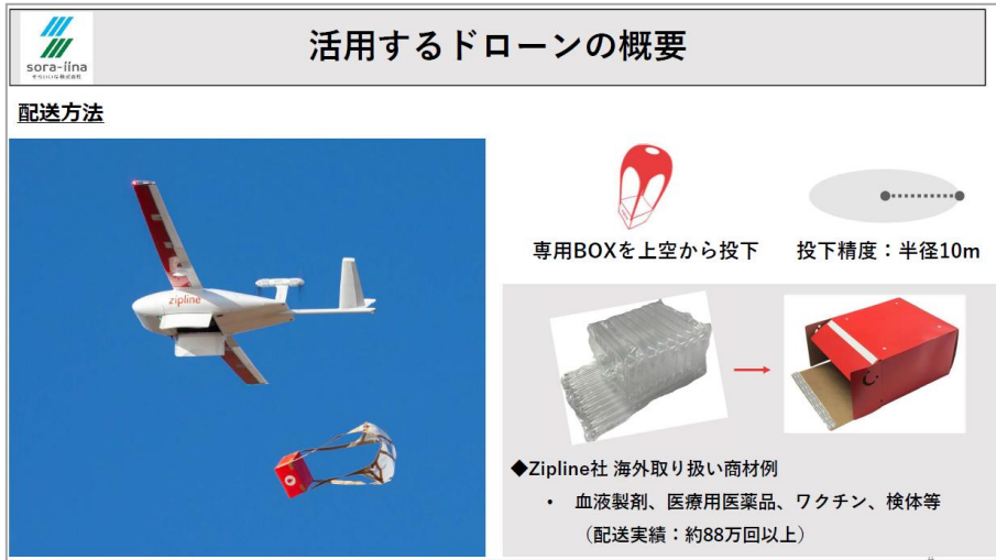
図 1-9-1-1. そらいいなが使用する米国 Zipline の機体のスペックとその配送方法
