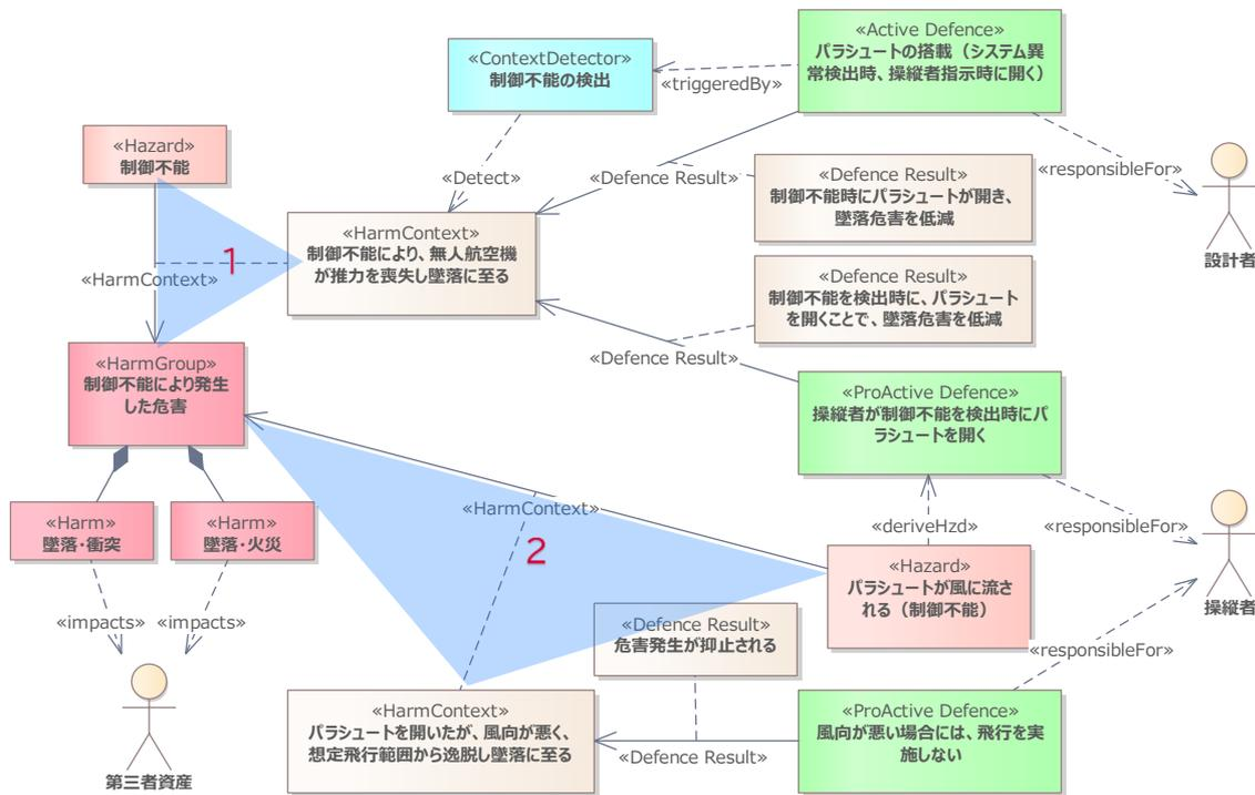
図 A1.1-1 SafeML を用いた飛行中断時のリスク構造分析
