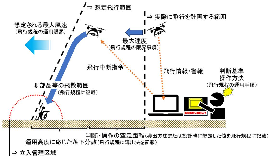
図 A1.1-2 飛行中断による安全の確保に必要な情報の例
