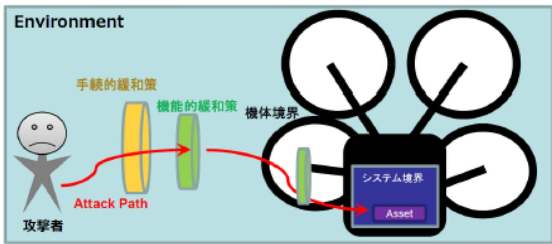
図 4.3-1 航空局ガイドライン セクション 115 内 機体境界、システム境界および資産の概念図
