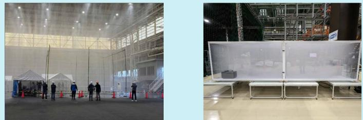
降雨試験による低視程の定量化と試験装置開発
