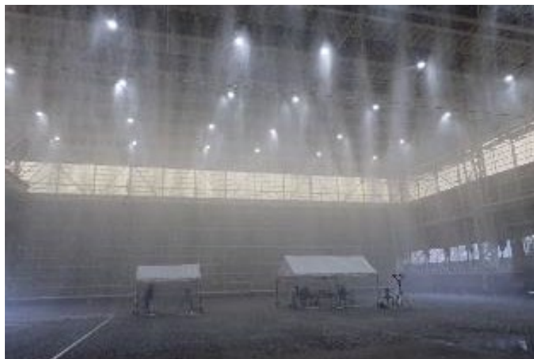
分光透過率計測試験@防災科研
