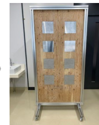
試験供試体（さび分布）の設計・試作
