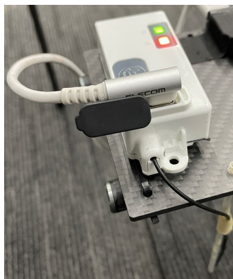
試験用リモートID機器
